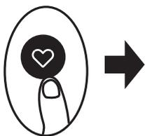
Presione este botón cuando el control remoto esté encendido, el sistema volverá automáticamente a la configuración anterior, incluido el modo de funcionamiento, la configuración de la temperatura, el nivel de velocidad del ventilador y la función de suspensión (si está activada).
