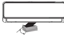
Si continúa presionando el botón SWING, se pueden configurar cinco direcciones de flujo de aire diferentes. La rejilla se puede mover en un cierto rango cada vez que presiona el botón. Pulse el botón hasta llegar a la dirección que prefiera.
